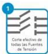
**Regla N°01 Desconectar la instalación:** El equipo o parte de él deberá desconectarse.
